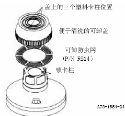
图 5. 卸下盖和防虫网进行清洗
